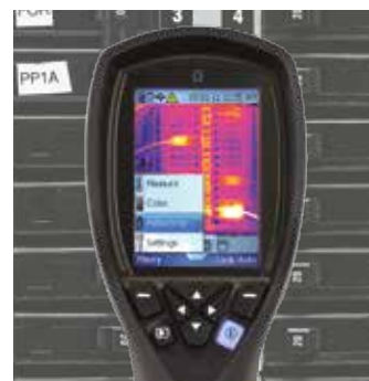
FLIR i7, Temperatur an 19.600 Punkten FLIR E60, Temperatur an 76.800 Punkten
