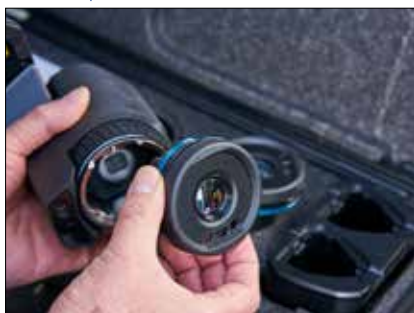
Sdílení objektivů (širokoúhlých a teleobjektivů) mezi více různými kamerami díky optice AutoCal™
