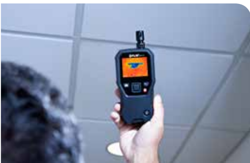
Technologia IGM wskazuje użytkownikowi, w którym miejscu ma wykonać pomiary
