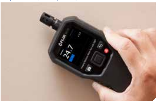
Sprawdzić wilgotność za pomocą bezbolcowego pomiaru
