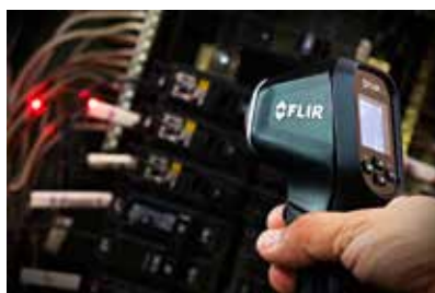
Einfache Identifizierung der Messstelle dank integriertem Laser
