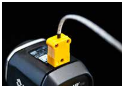
TG56 mit Eingang für Thermoelement (Typ K)
